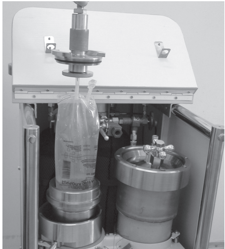
Рис. 2. Контейнер з робочою рідиною – фізіологічним розчином, вставлений у витиснювач рідини
